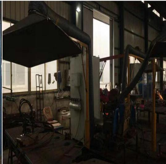
图 3-2 切割斜边脉冲除尘器
